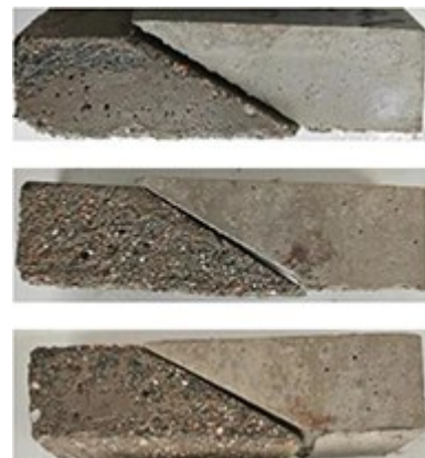
图 10 B-0.1 组在 75 次循环后损坏
