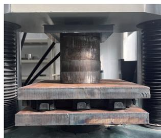
图 5 单个土工格室材料抗压性能试验
