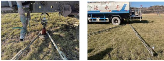
(a)荷载装置布设 (b)贝克曼梁及百分表布设
