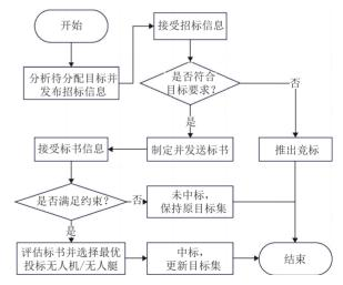
图 3 基于市场机制合同网的任务重分配示意图
