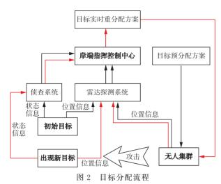
图 2 包含了目标预分配和目标实时分配的流程, 二者主要区别在于数学模型的建立和求解方法的选择。目标预分配可建立一个优化模型,求解该模型获得最优分配方案,但是计算时间长、计算量大;在目标实时分配阶段,由于其对实时性要求较高,因此通过求解优化模型的方法不再适用,此时需要通过更高效的方法得到一个较优的可行分配方案。
