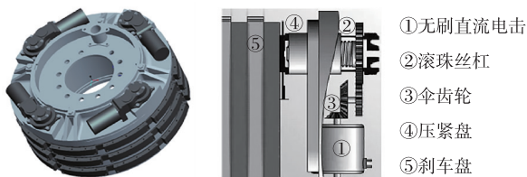
图 8 机电作动器及其作动结构
