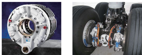
(a)电刹车装置 (b)刹车装置与机轮 图 6 B-787 飞机电刹车装置
