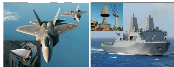
图2 采用FSS隐身技术的美国F-22战斗机与采用隐身桅杆的美国LPD-17船坞登陆舰
