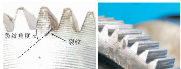
(a) 裂纹角度 (b) 齿根裂纹
