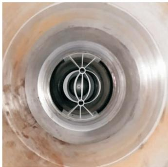
图 16 对涡旋流畸变网的安装
