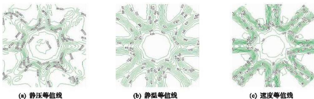
图3 引射器出口截面流场参数等值线局部放大图
