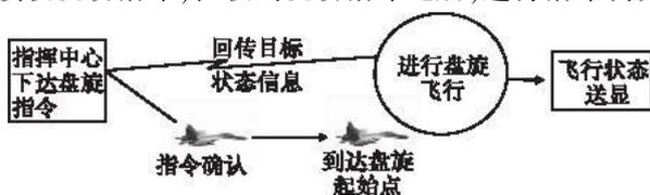
图4 盘旋机动的过程示意
