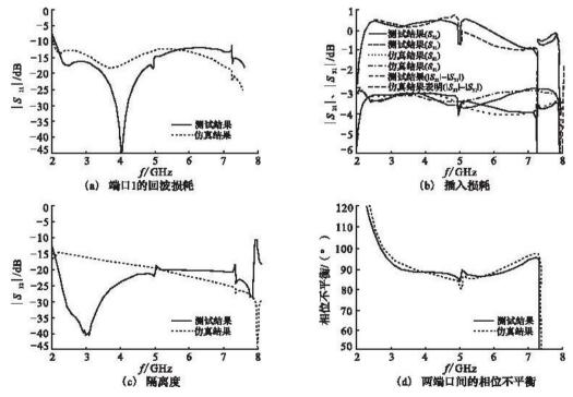
图 5 正交功分器的 S 参数仿真和测试结果
