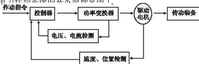
图1 电力作动系统的基本原理结构图
