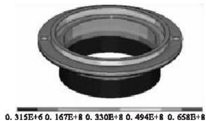
4 静环座 Von Mises 等效应力云图
