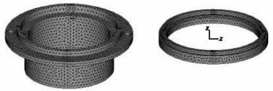
图 2 静环组件有限元模型
