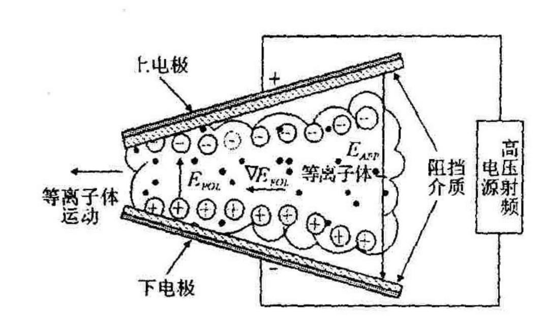
图 1 2 个倾斜平板电极间不稳定等离子体
