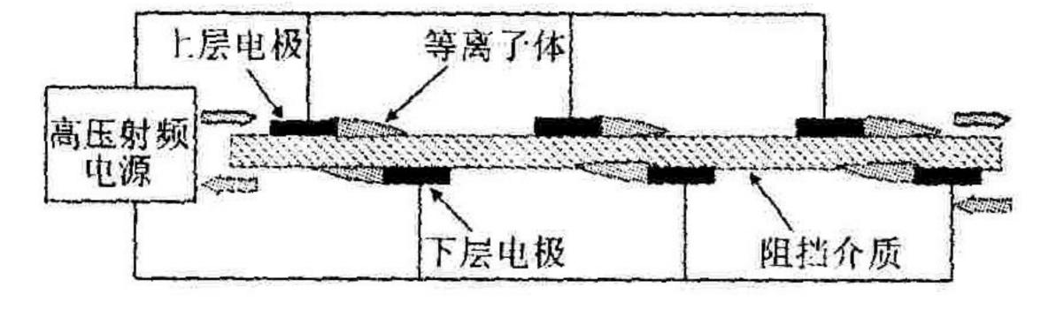
图 2 顺电流动加速机制示意图
