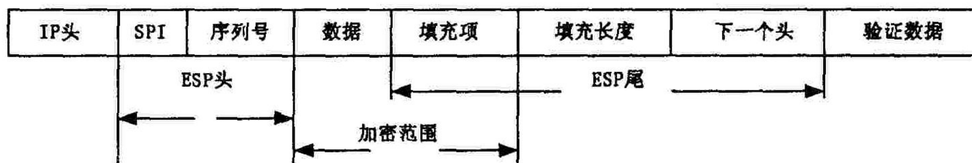
图 2 传送模式下受 ESP 保护的 IP 包
