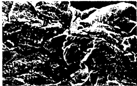
图 5 断口二次裂纹及腐蚀产物
