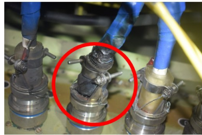
图 4 用电通道插头烧蚀故障图
