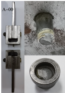
图 4 纯拉伸构型 A 典型破坏细节
