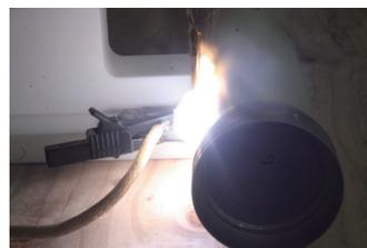
图 8 涂覆密封胶后电压击穿瞬间相机拍摄的电火花
