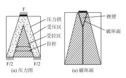
图 6 拉拱与楔劈模型示意图
