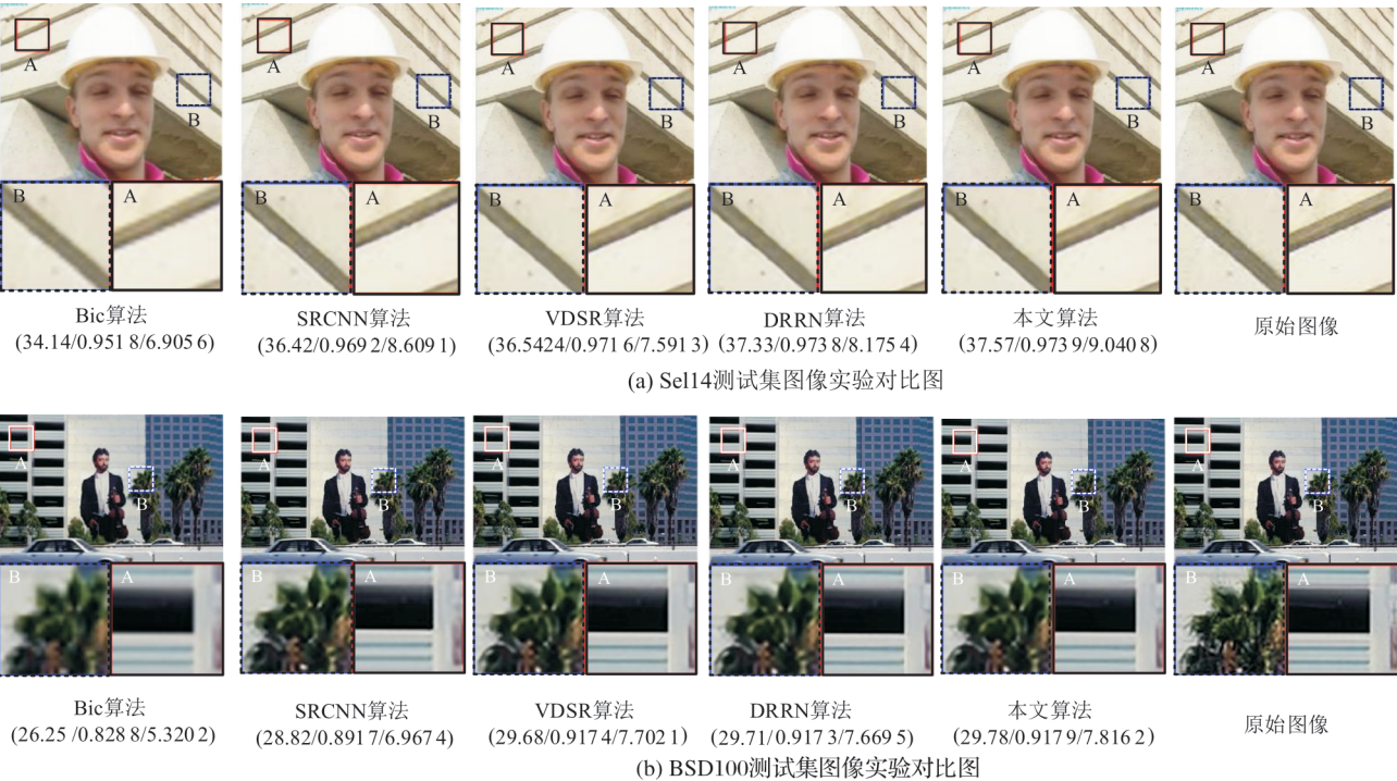
图 3 不同测试集图像的 PSNR/SSIM/IFC 对比图
