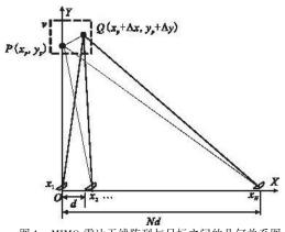
图 1 MIMO 雷达天线阵列与目标之间的几何关系图
