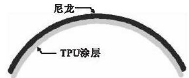
图 8 充气式机翼材料结构示意图
