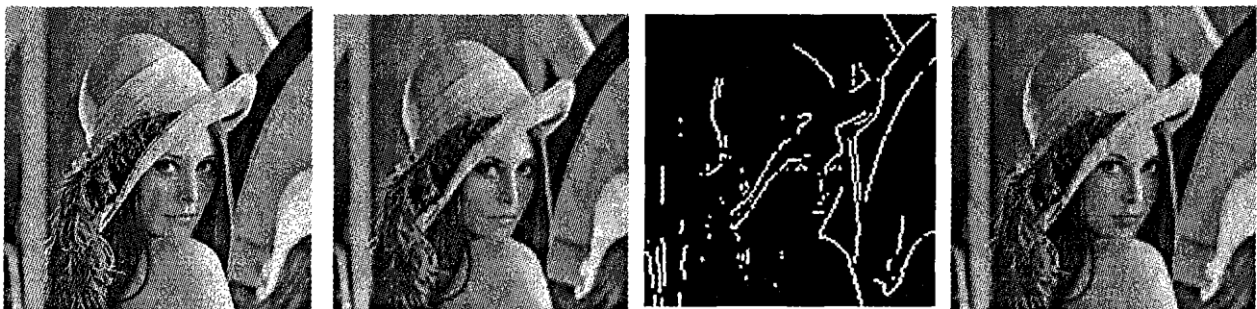
(a) lena 原图(256 × 256) (b)降采样图像(128 × 128) (c)边缘图像(128 × 128) (d)最近邻插值重建图像(256 × 256)
