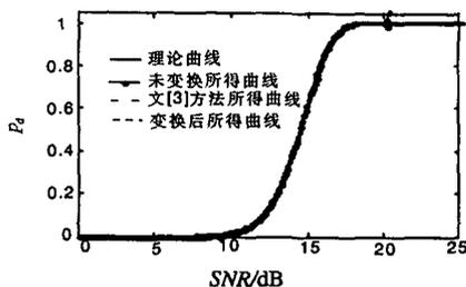
图5 恒定幅值检测概率
